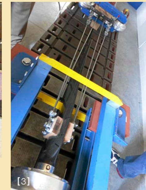
[1] Das Holz aus der Ukraine lagert so lange, bis es die nötige Reife erhält, um ein Propellerblatt zu werden. Die Herkunft des Materials ist genau dokumentiert. [2] Die CNC-Fräse formt ein neues Propellerblatt. [3] Zugtest an einem Propellerblatt im Zuge einer Zertifizierung.
