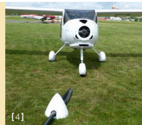
[4] Am Flugplatz Letnany bei Prag ist der Propeller der Virus SW in wenigen Minuten demontiert. [5] Die Schleifkontakte für die elektrische Verstellung waren wegen eines Einbaufehlers frühzeitig verschlissen. [6] Geschäft: Gemeinsam wird der gewartete Propeller wieder eingebaut.
