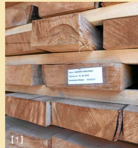
[1] Das Holz aus der Ukraine lagert so lange, bis es die nötige Reife erhält, um ein Propellerblatt zu werden. Die Herkunft des Materials ist genau dokumentiert. [2] Die CNC-Fräse formt ein neues Propellerblatt. [3] Zugtest an einem Propellerblatt im Zuge einer Zertifizierung.
