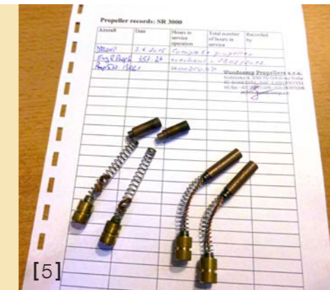
[4] Am Flugplatz Letnany bei Prag ist der Propeller der Virus SW in wenigen Minuten demontiert. [5] Die Schleifkontakte für die elektrische Verstellung waren wegen eines Einbaufehlers frühzeitig verschlissen. [6] Geschäft: Gemeinsam wird der gewartete Propeller wieder eingebaut.
