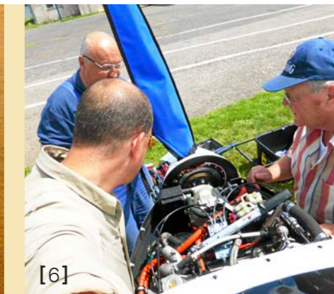
[4] Am Flugplatz Letnany bei Prag ist der Propeller der Virus SW in wenigen Minuten demontiert. [5] Die Schleifkontakte für die elektrische Verstellung waren wegen eines Einbaufehlers frühzeitig verschlissen. [6] Geschäft: Gemeinsam wird der gewartete Propeller wieder eingebaut.
