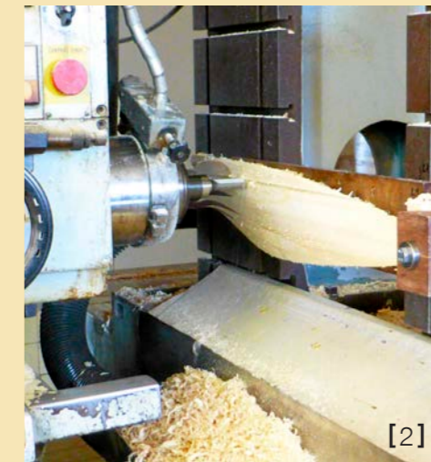
[1] Das Holz aus der Ukraine lagert so lange, bis es die nötige Reife erhält, um ein Propellerblatt zu werden. Die Herkunft des Materials ist genau dokumentiert. [2] Die CNC-Fräse formt ein neues Propellerblatt. [3] Zugtest an einem Propellerblatt im Zuge einer Zertifizierung.
